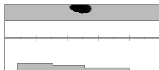
Une vérification depuis une autre direction indique plus clairement les propriétés ferreuses de ce même boulon.
