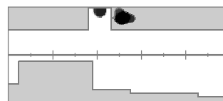
Traces cibles d'une pièce de monnaie canadienne de 10 cents de 1998 (acceptée) et d'un clou directement adjacent (rejetée).
